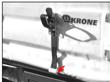
Crochet sangle (élargissement du crochet)
