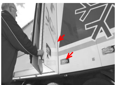
Paroi accordéon (fonctionnement)
