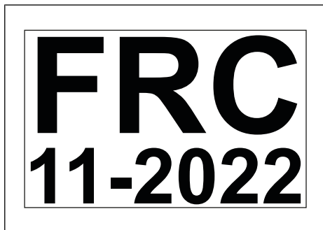
Fig. 8-8: Esempio di targhetta di omologazione ATP
