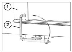
Fig. 6-6: Swivelling the door stop upwards
