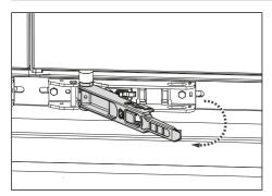
Fig. 6-2: Swivelling out the door lock lever
