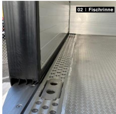
**02 Fischrinne.** Für den Transport von frischem Fisch ist eine speziell konzipierte Wasserrinne quer vor den Hecktüren im Boden eingelassen. Mit optimiertem Auffangvolumen und zentralem Wasserablauf, ermöglicht diese eine kontrollierte Entsorgung von anfallendem Leckwasser und lässt sich zudem, dank der integrierten, herausnehmbaren Revisionsabdeckungen, einfach und ohne großen Zeitaufwand reinigen. Ein großzügiger Edelstahltank dient zur Aufnahme der Flüssigkeiten.
