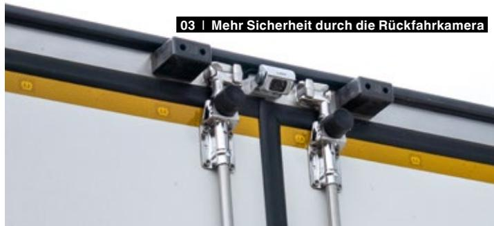
03 | Mehr Sicherheit durch die Rückfahrkamera
