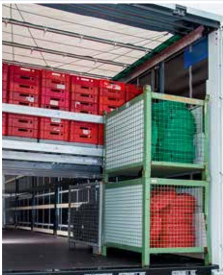
Die Doppelstockeinrichtung besteht aus 12 längsseitigen Ladebalken mit einem Lochraster zur Aufnahme der Querbalken. 23 Ladebalken sind für die Queranordnung vorgesehen. Damit ergeben sich 33 Palettenstellplätze in der 2. Ladeebene, die mit jeweils max. 320 kg belastet werden können.
