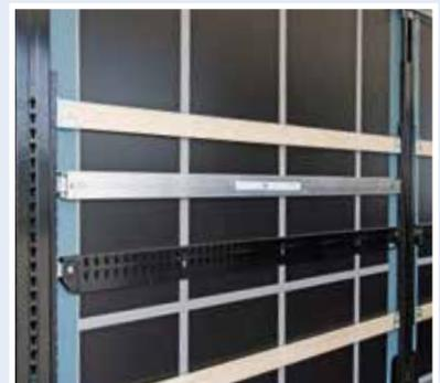
5 Paar Mittelrungen teilen den Aufbau in 6 Felder (5 x ca. 2.280 mm und 1 x ca. 1.076 mm, hinten). Bei Nichtverwendung der Ladebalken können diese einfach als "Einstecklatten" längsseitig zwischen den Mittelrungen verstaut werden
