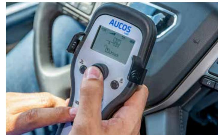
Die Einstellung des Containerchassis auf alle Container von 20 bis 45 Fuß kann der Fahrer per Knopfdruck aus dem Fahrerhaus einleiten.
